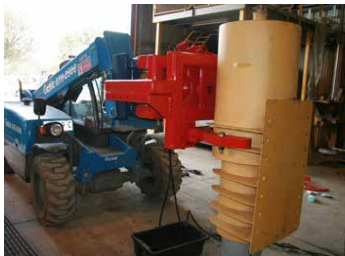
O Engate Rápido Universal Trilift em uma Genie removendo uma suspensão
