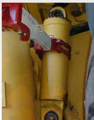
A Garra de Cilindro Universal Trilift removendo cilindro
