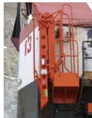
RTV-CF en la excavadora en posición elevada
