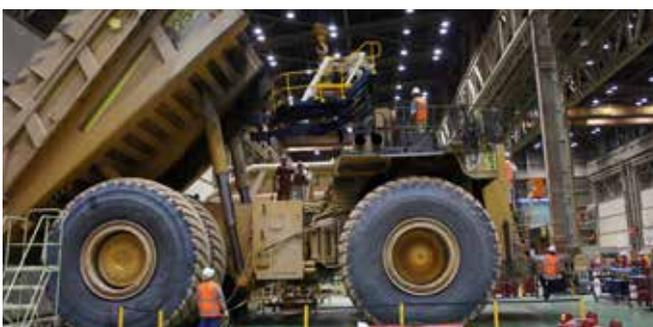
Montacargas de Transmisión CAT 797 Trilift® sacando la transmisión
