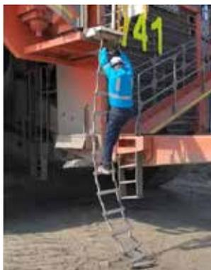
Ilustración de la Escalera Modelo EE instalada en una excavadora en las posiciones Arriba y Abajo.
