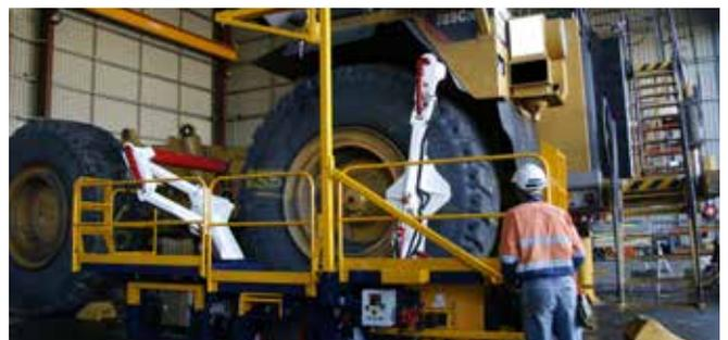
Manipulador de Neumáticos para el Taller TH15000 Trilift® sacando un neumático de Cat 789C
