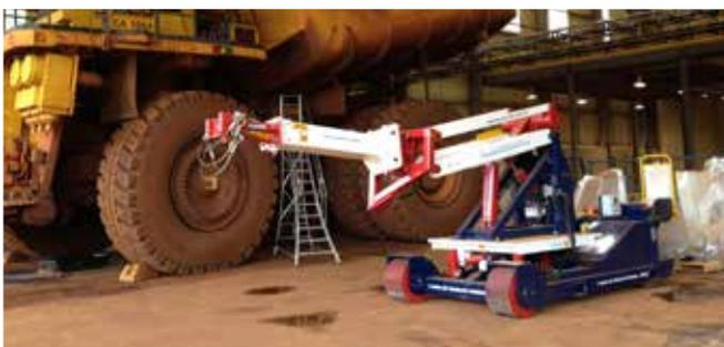
Mesa de Trabajo Variable Trilift® con Multijig y Manipulador de Cilindros
