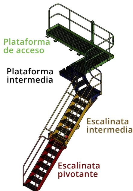
Esta ilustración muestra las secciones que conforman la RT-45.
