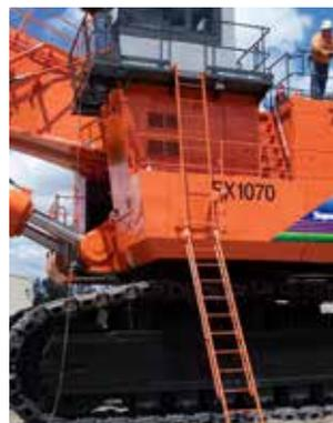
Ilustración de la Escalera Modelo EF instalada en una excavadora en las posiciones Arriba y Abajo.
