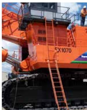
Escada EF montada na escavadeira nas posições estendida e retraída
