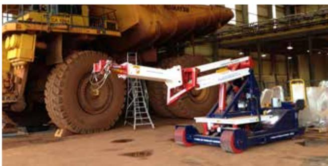
Remoção de cilindro de elevação com o Multijig e a Garra Universal para Cilindro Trilift®
