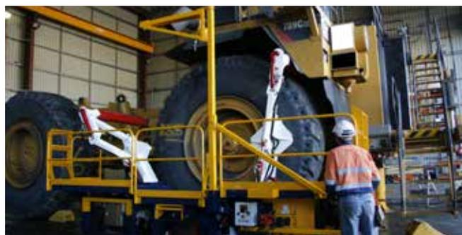
Manipulador de Pneu para Oficina removendo pneu Cat 789C
