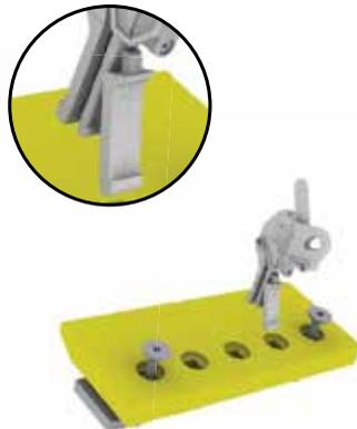
Instale os adaptadores apropriados ao dispositivo Lever Pin N Lift para encaixe no buraco da borda cortante.
