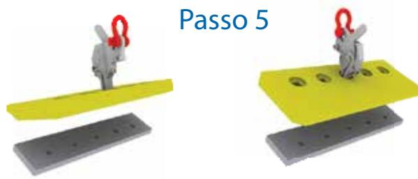
Levante a borda cortante permitindo que ela se incline para frente.
