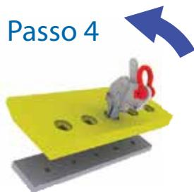
Empurre a alavanca para travar o Lever Pin N Lift, alinhando os olhais de içamento.
