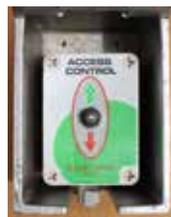
1. Um controle remoto projetado para permitir a elevação ou rebaixamento do sistema de fora da cabine do veículo ou a nível do solo.
