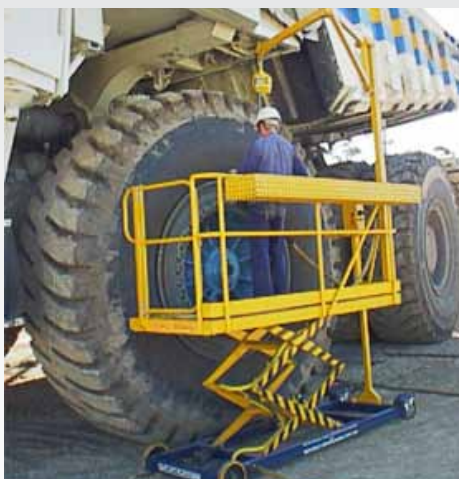
Plataforma de trabajo de altura variable Trilift ® en uso
