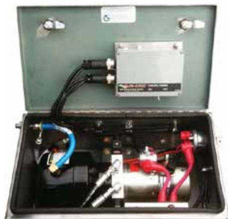
El **Generador Safe-Away® 2009 serie VHS** se activa con el Sistema de Control de Acceso. La cabina de acero inoxidable del Generador VHS contiene la hidráulica del control principal y los componentes eléctricos. Incluye:
