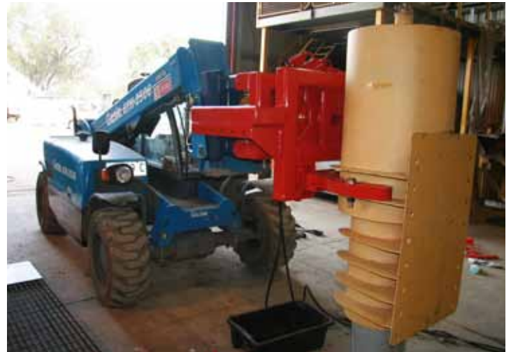
Retiro de una suspensión con un Adaptador de Enganche Rápido Trilift® en un Genie
