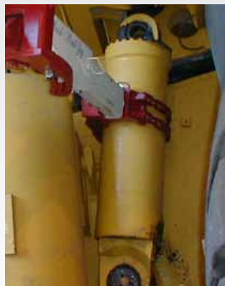
La Abrazadera de Cilindros Universal Trilift® retirando un cilindro
