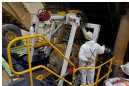
Подъемник для трансмиссии Trilift® Cat 797, снимающий трансмиссию.
