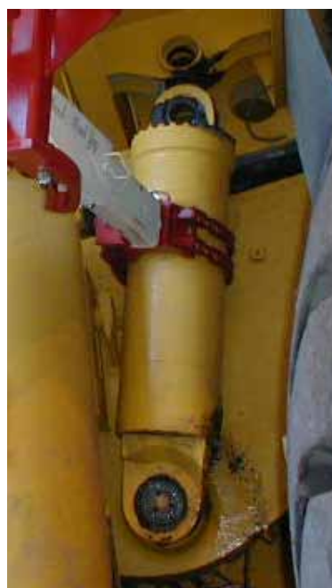
Универсальный хомут для цилиндра Trilift®, снимающий цилиндр
