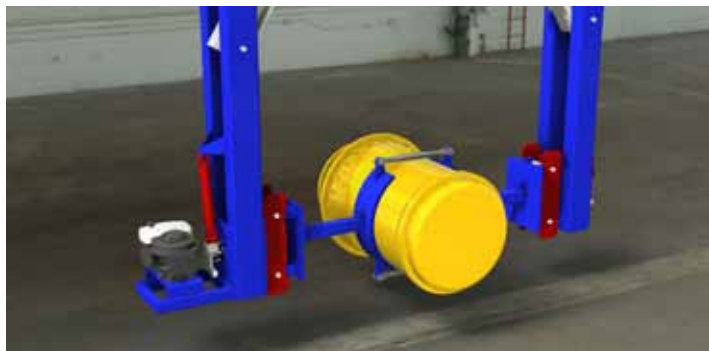
Поворачивающее устройство для компонентов Trilift® CR20000, манипулирующее крупным колесным двигателем.
