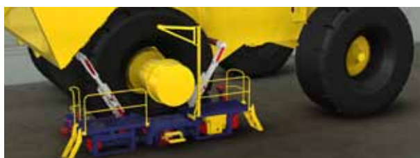
Цеховой шинный манипулятор Trilift® TH15000, снимающий крупную внутреннюю шину.
