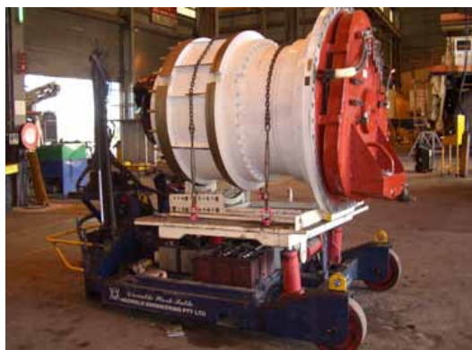
Снятие колесного двигателя с использованием универсального зажимного приспособления для электрических колесных двигателей Trilift®.
