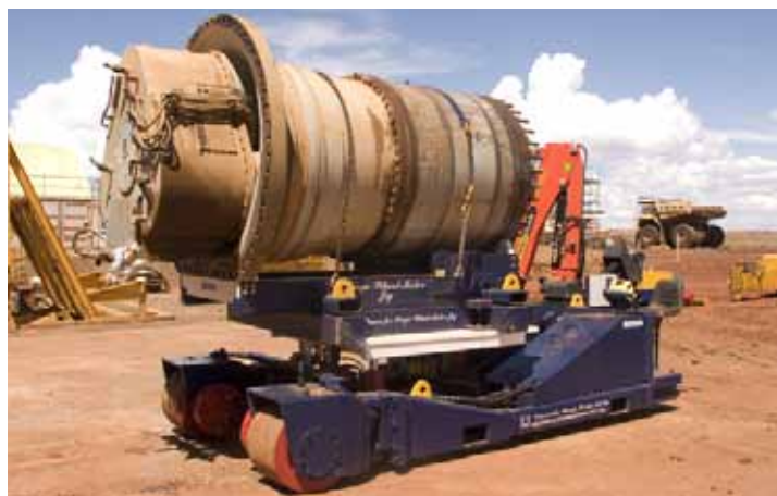
Trilift® VWT XC30 с колесным двигателем, снятым с Terex MT6300
