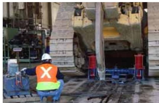
Домкратная опора Trilift® модели 100, поднимающая бульдозер.
