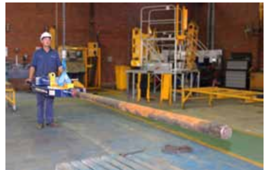
Балансировочный инструмент для компонентов Trilift® используется вместе с краном-балкой для снятия оси карьерного самосвала
