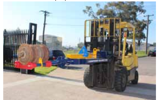
Балансировочный инструмент для компонентов Trilift® используется вместе с вилочным погрузчиком
