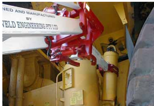
Снятие цилиндра подъема с использованием Trilift® Multijig и универсального хомута для цилиндра.
