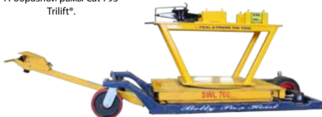
Штифт и монтажный блок А-образной рамы Cat 793 Trilift®.
