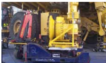
Универсальное зажимное приспособление для ступиц и подпирющих стоек Trilift®, используемое в VWT XC20.
