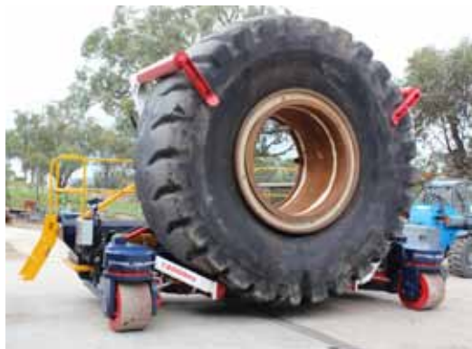
Цеховой шинный манипулятор Trilift® TH15000 с шиной и ободом.
