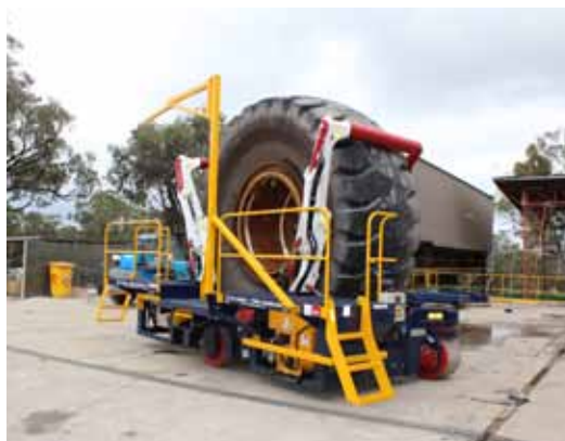
Цеховой шинный манипулятор Trilift® TH15000 с шиной и ободом
