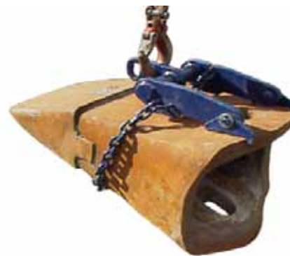
Цепной N-образный подъемник Trilift®, прикрепленный к зубу ковша экскаватора.
