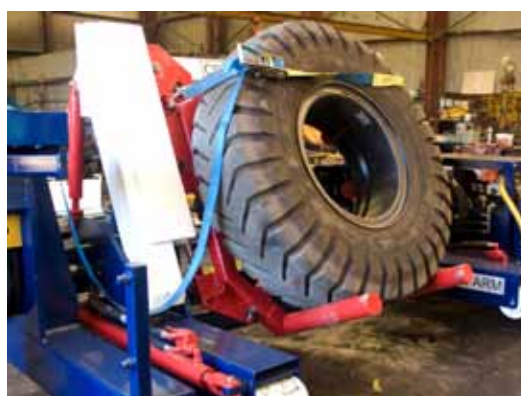
Trilift® TH2000, показанный с шиной в наклонном положении
