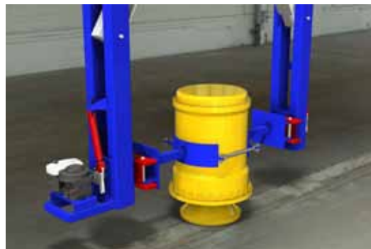
Поворачивающее устройство для компонентов Trilift® CR20000, манипулирующее крупным колесным двигателем.
