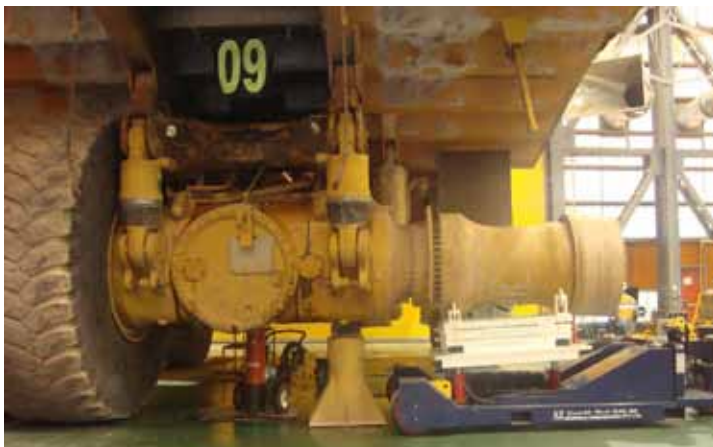
Снятие последнего звена привода Cat с использованием Trilift® VWT XC25 и универсального зажимного приспособления для задней колесной группы Trilift®
