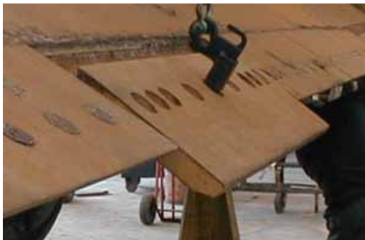
Удаление режущей кромки с использованием инструментальной оснастки N-образного подъемника для наклонной плоскости Trilift®
