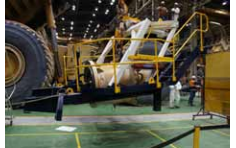
Trilift® Cat 797变速器起重装置举升并将变速器下放至地面
