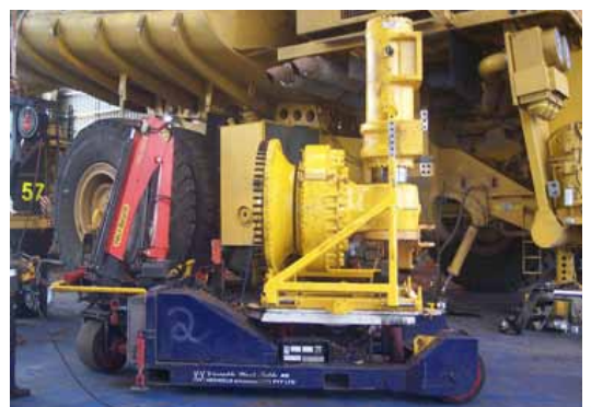
VWT XC20上使用Trilift® 通用轮毂和支柱属具
