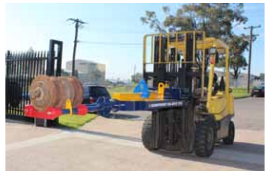
Trilift® 部件平衡工具配合叉车使用
