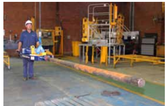
Trilift® 部件平衡工具配合天吊拆卸牵引车轴
