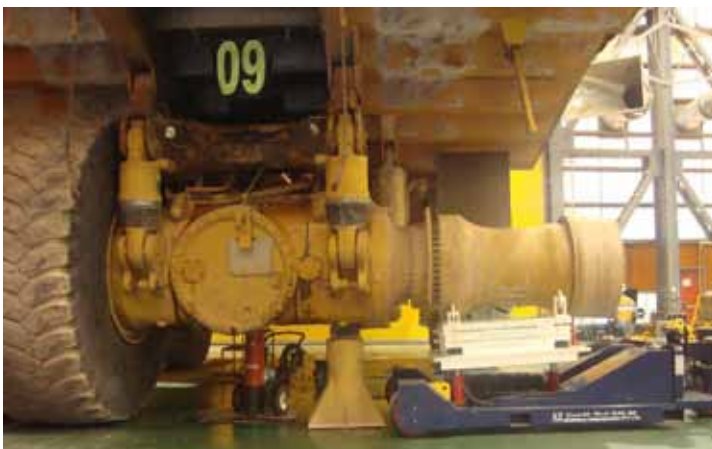
使用Trilift® VWT XC25 和 Trilift® 通用后轮组件属具拆卸Cat最终驱动
