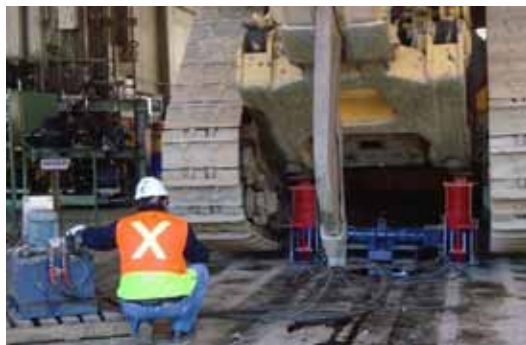
Trilift® 千斤顶型号100举升推土机
