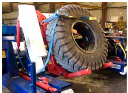
Trilift® TH2000操作轮胎处于倾斜状态
