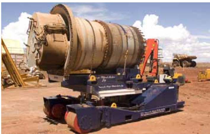
使用Trilift® VWT XC30拆卸Terex MT6300轮式电机
