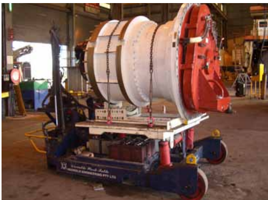
使用Trilift® 通用电动轮属具拆卸轮式电机
