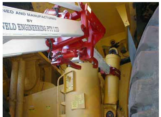
使用 Trilift® 多功能属具和通用油缸夹拆卸举升油缸
