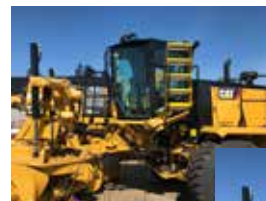
Escalera RotorStep M3 aplicada en una motoniveladora CAT 18M3
