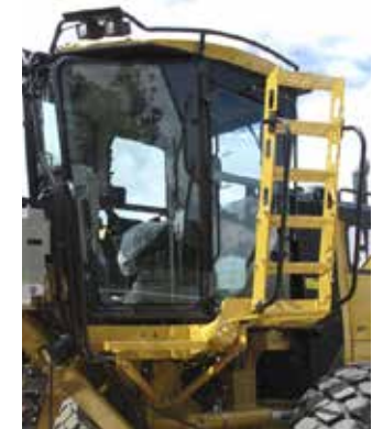
Escalera RotorStep GM en una Niveladora 16M
