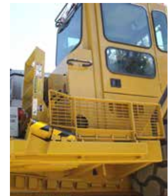
Escalera RotorStep S en una Niveladora Cat 657
