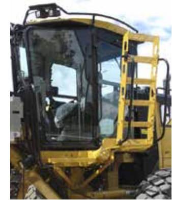
Escalera RotorStep GM en una Niveladora 16M
