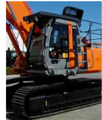
Escalera RotorStep L en una excavadora Hitachi EX350
