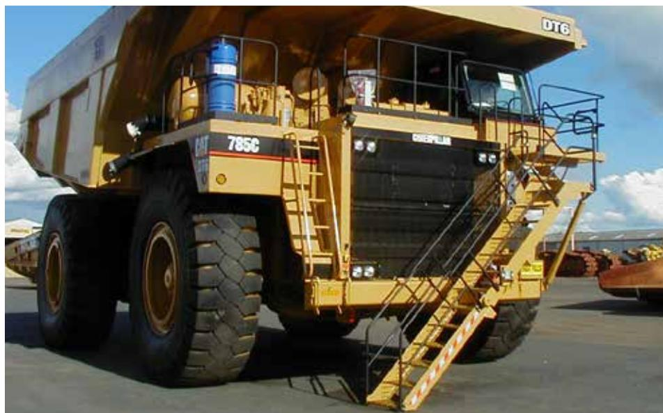
La **Escalinata Safe-Away® RT45** se muestra en un camión Cat 785C (arriba) y en un carro de agua Cat 777D (abajo).
