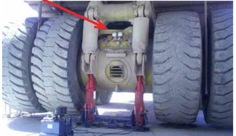
Locación para el engate de la suspensión trasera Hitachi
