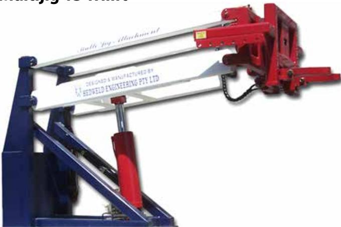
Diseñado para integrarse con la VWT 15 Trilift®, el Multijig 15 se atornilla directamente a la mesa previamente perforada para asistir en el retiro de componentes.
