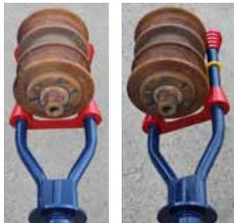
La Herramienta de Balance de Componentes Trilift® incluye un Adaptador de Eje (N° de pieza HW75366) para asistir en el retiro de ejes.
