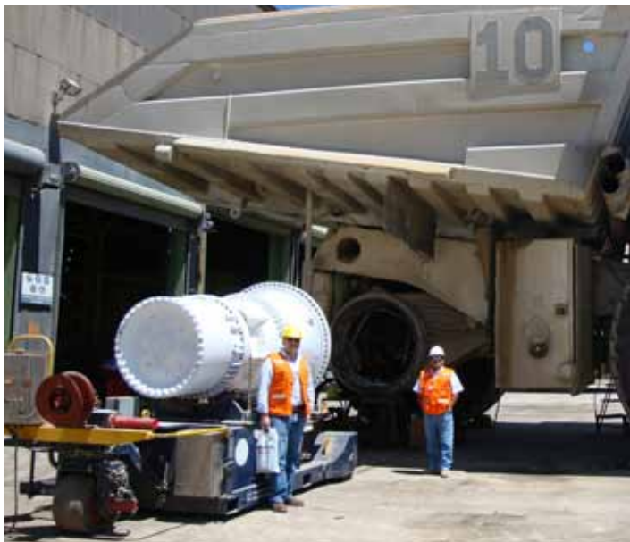
VWT XC20 com o Dispositivo Universal para Roda Motriz de Grande Porte
